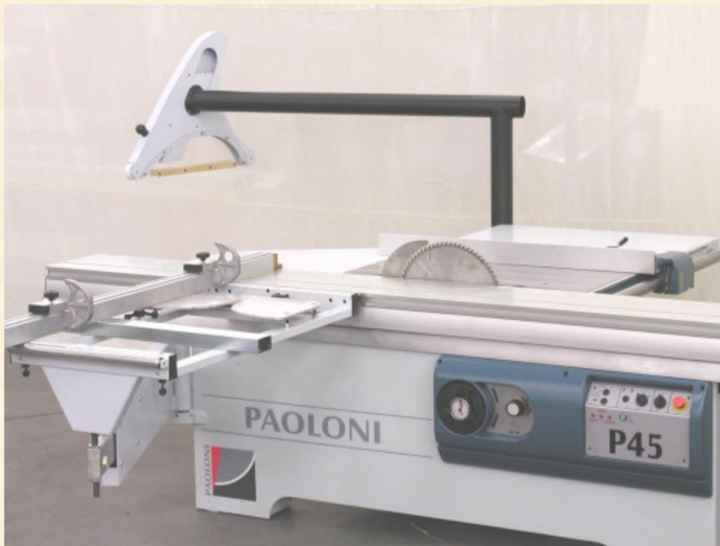
Protezione lama a norme CE con supporto girevole, permette una immediata liberazione del piano.
