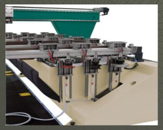
Magazzino laterale per utensili ed aggregati di grosse dimensioni.
