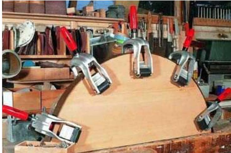
*Bügel aus Druckguss. Spindel verzinkt. Handgerechter Holzgriff, rot lackiert. Bewegliche Spannbacken aus Druckguss mit Rückstellfeder. Gut haftender Gummibelag.*
