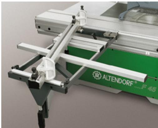
Der Klappanschlag mit integriertem Längenausgleich erleichtert das präzise Schneiden von Winkeln und Gehrungen in einer Funktion. Die schräg angeordneten Maßskalen sind gut ablesbar. Die spielfreien und robusten Anschlagklappen sind leicht zu verstellen. Diese ist mit einer zusätzlichen Werkstückauflage versehen, zur Unterstützung bei instabilen Werkstücken.
