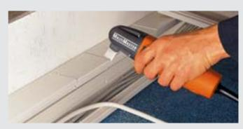
Sägen von Holz, Kitt und weichen Materialien. Sägeblätter aus HSS auch für GFK, CFK und Blech bis 1 mm. Gekröpfte Sägeblätter ermöglichen das Arbeiten plan zur Oberfläche. Die Segmentierung erlaubt Schnitte im rechten Winkel ohne Überschnitt.
