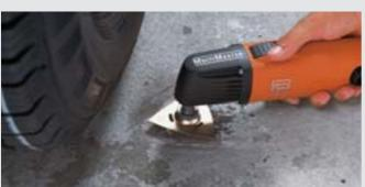
Ölflecken auf Garagenböden, Graffiti an Beton- und Steinfassaden oder andere Rückstände verschwinden unter der hartmetallbestückten Raspel.
