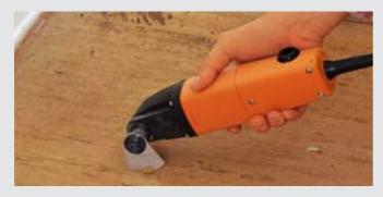
Mit dem Segmentmesser schneiden Sie starre Materialien, z.B. Bodenbeläge aus Kunststoff, Gummi, Karton, Leder, Drahtgewebe, Schlingenware/Teppichboden u.v.a.
