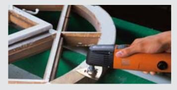
Grobschliff mit den HM-Raspeln. Unschlagbar in puncto Abtragsleistung und Standzeit.
