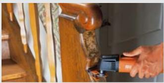
Mit den sechs auswechselbaren Profileinsätzen des Profil-Schleifsets schleifen Sie an beengten Stellen, in Nuten und an Profilen ganz bequem und mit dreimal höherer Abtragsleistung. Die flexiblen Hohlprofile passen sich unterschiedlichen Bedingungen perfekt an.
