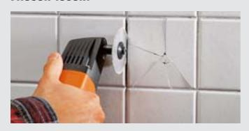
Mit dem Diamant-Sägeblatt trennen Sie Marmor- und Trassfugen aus und fräsen Schlitze in Putz, Backsteine, Bimsund Wabensteine sowie in Gasbeton.
