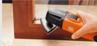
Die Schleifplatte mit Kunststoffträgerplatte verursacht keine Kratzspuren.
