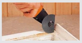
Mit den Sägeblättern entkitten Sie Einfach- und Verbundverglasungen ohne Glasbruchgefahr, ohne aufwändige Vorarbeiten.
