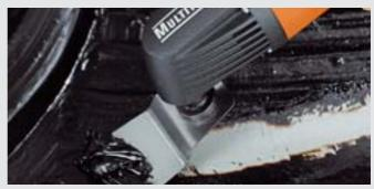
Der feste Spachtel findet Einsatz beim Ablösen von Unterbodenschutz, Teppich- und Fliesenkleberresten, Zunder und schadhaften Beschichtungen etc.
