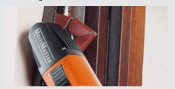
Mit dem Kleeblattpapier kommt man in Vertiefungen, Rillen und Nuten. Das Schleifmittel wird um eine spezielle Schleifplatte gelegt, sodass von drei Seiten geschliffen werden kann.
