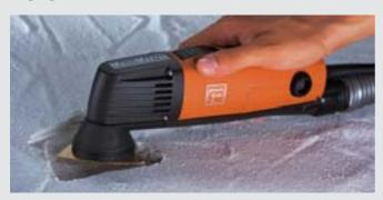
Mit der HM-Raspel schleifen Sie Zement, Beton, Stein, Putz, Fliesenkleber, Lack und Holz.
