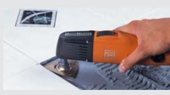
Die HM-Raspel bringt optimale Ergebnisse beim Planschleifen von Fliesenkleber, Schleifen von Fliesenrändern, Grobschliff von Holz, Spachtelmasse, Lack u.v.m.
