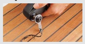
Das Schneidmesser zum schnellen und sicheren Austrennen von Stabdeck-Fugenmaterialien eignet sich auch für Problemstellen wie Kajütenaufbauten, Poller, Dollborden, Klampen und Kurven.
