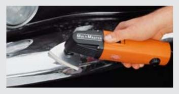
Mit den Filzpolierplatten werden Metallteile perfekt aufpoliert.
