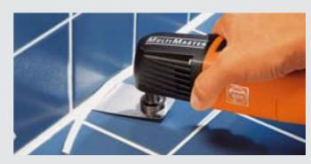
Elastische Dichtstoffe, Farbanstriche, Klebemittelreste, Aufkleber im Wohn- und Sanitärbereich etc. entfernen Sie mit dem flexiblen Spachtel. 2er-Pack.
