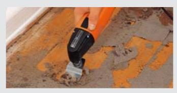
Teppich- und Fliesenkleberreste, Zunder, Unterbodenschutz und schadhafte Beschichtungen entfernen Sie einfach mit dem festen Spachtel.
