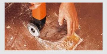
Mit den HSS-Sägeblättern sägen Sie GFK, CFK, Holz und Blech bis 1 mm. Gekröpfte Sägeblätter ermöglichen das Arbeiten plan zur Oberfläche. Die Segmentierung erlaubt Schnitte im rechten Winkel ohne Überschnitt.
