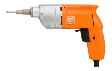
Gewicht 1.6 kg 125 W Leistungsabgabe Nennaufnahme 230 W Lastdrehzahl 0-450 1/min Leerlaufdrehzahl 0-800 1/min Holzschrauben Ø 6 mm Werkzeugaufnahme 7 mm Schrauben M 6 Kabel mit Stecker 5 m Max. Anziehdrehmoment 12 Nm
