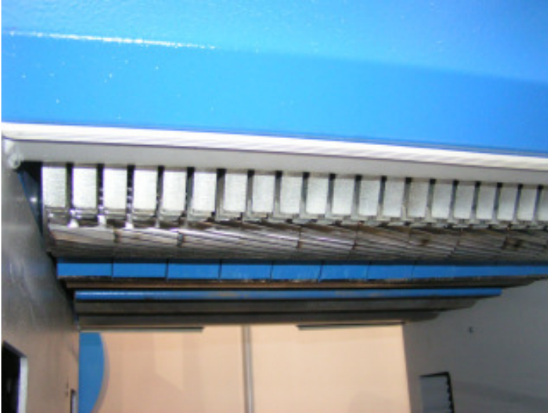
Rückschlagsicherung und geteilte Einzugswalze
