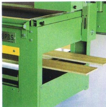
Die optimale Anordnung der gesamten Bedienelemente mit dem stufenlos einstellbaren Druckkontaktmanometer bietet höchsten Bedienungskomfort. Hochwertige Hartaluminium Elektroheizplatten mit einer frei programmierbaren elektronischen Temperaturregelung von 0-100° C ermöglichen einen zügigen Arbeitsablauf und beste Preßqualität.
