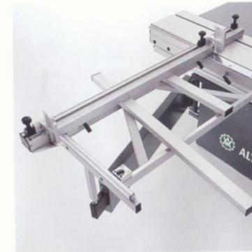
■ **Der Winkelanschlag.** Der robust gelagerte Winkelanschlag ermöglicht das präzise Schneiden von 90°-Winkeln. Alle Einstellwerte sind über die schräg angeordneten Maßskalen gut ablesbar. Die spielfreien und robusten Anschlagklappen können leicht verschoben und als Einzelklappe über den gesamten Ablängbereich eingestellt werden.
