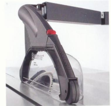
■ **Die Absaughaube.** Die Altendorf Schutzhaube überzeugt durch eine strömungsoptimierte Konstruktion. Mit wenigen Handgriffen lässt sie sich von breit auf schmal umstellen. Die Haube ermöglicht eine maximale Schnitthöhe von 125 mm (unabhängig vom Vorritzaggregat) und ist komplett seitlich wegschwenkbar.
