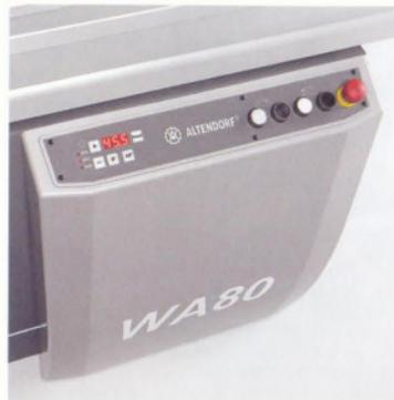
■ **Bedienpaneel am Maschinenständer.** Auf dem Bedienpaneel am Maschinenständer sind alle Funktionen übersichtlich angeordnet. Per Knopfdruck steuern Sie die Höhen- und Schwenkverstellung des Hauptsägeblatts. Der Schwenkwinkel wird im digitalen Display gut lesbar angezeigt.
