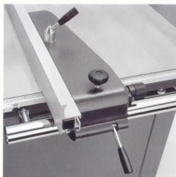
■ **Parallelanschlag mit manueller Feineinstellung.** Die manuelle Feineinstellung erleichtert die präzise Einstellung des Parallelanschlags. Per Verstellechraube wird der Anschlag millimetergenau justiert.
