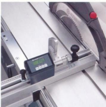
■ **Winkelanschlag DIGIT L.** Dieser Winkelanschlag verfügt über eine digitale Längenanzeige mit Feineinstellung, die  $\pm 1/10$  mm genaues Einstellen ermöglicht. Der Ablängbereich beträgt 150 – 3 200 mm. Der erforderliche Eichvorgang, z. B. beim Sägeblattwechsel, erfolgt schnell und einfach über Tasten – genau wie die Anwahl der Anschlagklappen. Die Elektronik ist dauerhaft eingeschaltet und somit immer einsatzbereit.
