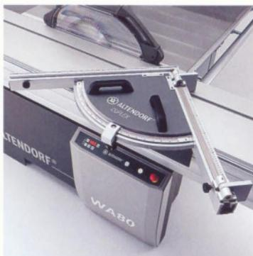
■ **Doppelseitiger Gehrungsanschlag DUPLEX.** Die DUPLEX Anschläge erlauben Winkelschnitte von 0–90° sehr schnell, genau und stufenlos. Bei 45° kann die Gehrung beidseitig am Werkstück ohne Verstellung der zwei Anschläge geschnitten werden. Die Maßeinstellung erfolgt über Lupe, Maßskala und Skala für den Längenausgleich. Auch als DUPLEX D mit digitaler Winkelanzeige erhältlich.
