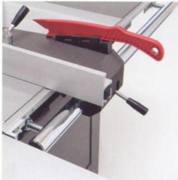
■ **Parallelanschlag.** Der Parallelanschlag ist leichtgängig und präzise verstellbar. Seine Leichtgängigkeit erhält der Anschlag über das hart verchromte Rundstangensystem. Sollen große Platten aufgeteilt werden, kann er mit einem Griff unter die Tischebene geschwenkt werden.
