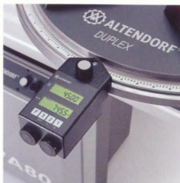
■ **DUPLEX DD.** Der DUPLEX DD ist weltweit patentiert. Die großen Vorteile: Aufwendiges Umrechnen und Nachmessen sowie Probeschnitte entfallen. Die exklusiv von Altendorf entwickelte, hochpräzise elektronische Einheit des DUPLEX DD errechnet das Längenmaß in Abhängigkeit zum Gehrungswinkel auf beiden Seiten des Anschlags und zeigt beide Werte digital an. Alle DUPLEX Varianten sind problemlos auf der gesamten Wagenlänge positionierbar.
