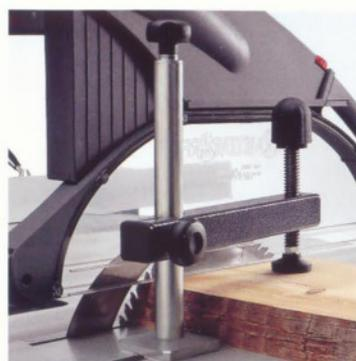
■ **Manueller Schnellspanner.** Der manuelle Schnellspanner ist mühelos auf dem Doppelrollwagen positionierbar und lässt sich ebenso leicht fixieren. Womit das Werkstück unverrückbar auf dem Wagen und am Winkelanschlag anliegt. Ein Mehr an Sicherheit, das nicht viel kostet.
